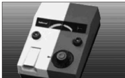
Figura 4 - Reflomat meter (adaptado da referência 1).
