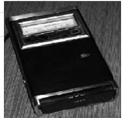
Figura 2 - Dispositivo para determinação da glicose sanguínea com base na reflectância - Ames Eye-tone (adaptado da referência 1).
